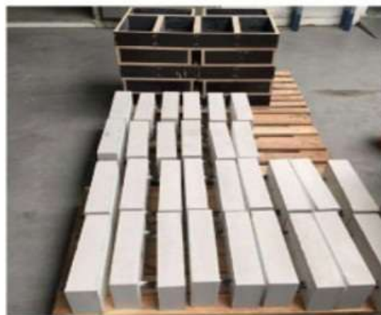
6. ábra Laterális vízvándorlási teszt minták előkészítése, a membrán áttörésének létrehozása
